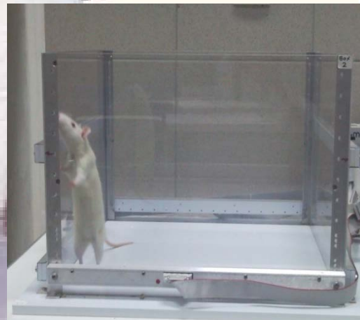
Εικόνα 3: Πειραματική διάταξη πρότυπου μέτρησης κινητικής δραστηριότητας σε κλωβό με φωτοκύτταρα (ENV515 Activity Monitor, Version 5, Med Associates). Ο επίμυς εκφράζει κάθετη κινητικότητα (ανόρθωση, επάνω εικόνα) και οριζόντια κινητικότητα (κάτω εικόνα).
