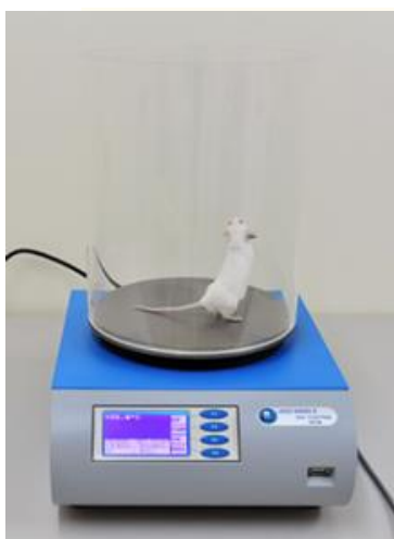
Εικόνα 1. Θερμή/Ψυχρή πλάκα (Ugobasile.com)
