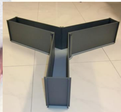
Εικόνα 4. Λαβύρινθος σε σχήμα Υ (Ugobasile.com)
